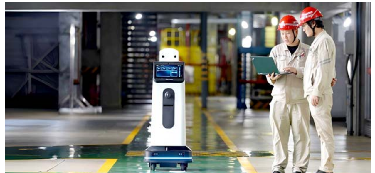
高井热电公司智慧安防系统，工作人员对巡检机器人进行日常维护和调试
